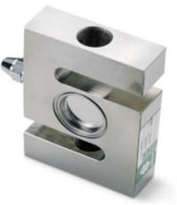
El principal funcionamiento de ésta celda es que en su interior hay una resistencia llamada galga extensiométrica o extensómetro conectada a la estructura de la celda, la cual tiene la capacidad de comprimirse y estirarse según sea necesario.
